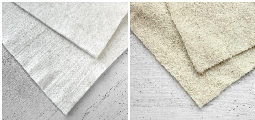
Рис. 1. Нетканые полотна на основе льняной (а) и конопляной (б) целлюлозы.
