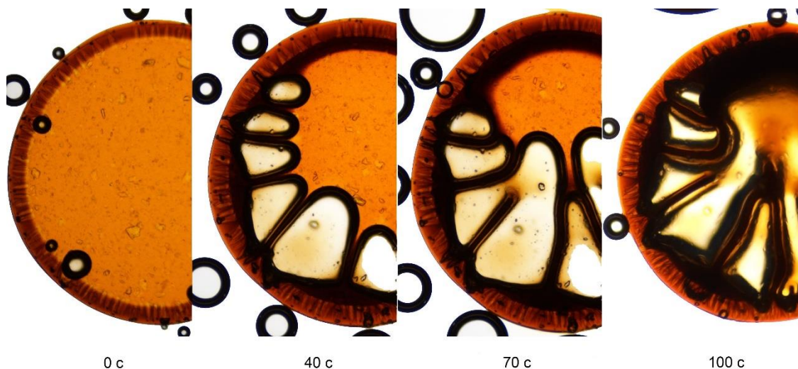
Рис. 2. Динамика осаждения раствора ПАНИ-О содержащего гидрокарбонат натрия 5%-м раствором серной кислоты во времени.
