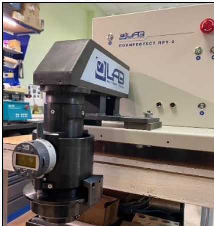
Рис. 1. Информационно-измерительная система для определения твердозерности пшеницы, включающая прибор «Полиреотест- ПРТ-2» и лабораторный измельчитель зерна «ЛИЗ-1».
